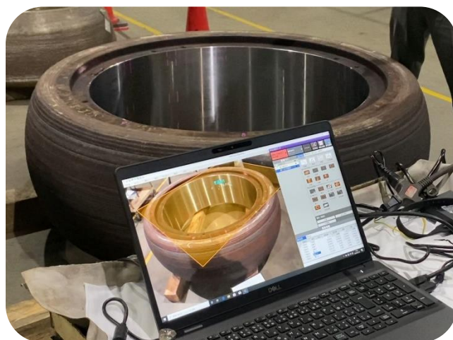
ミルローラの計測状況
