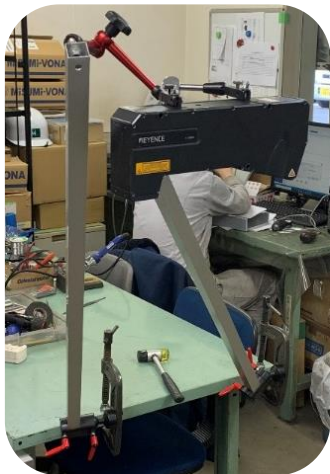
可変アームによる計測状況
