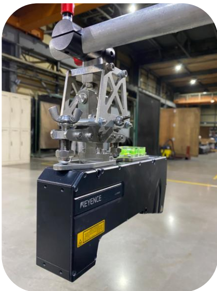
可変治具による計測状況
