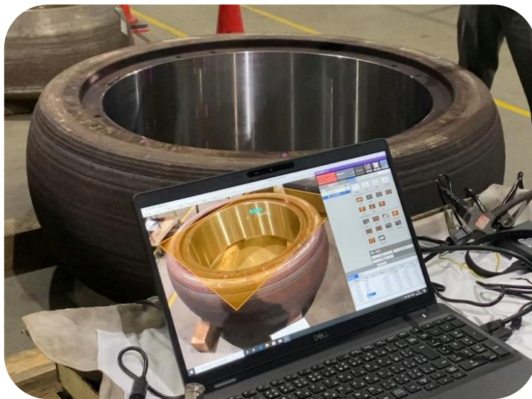
ミルローラの計測状況
